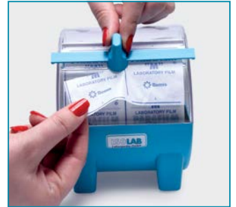
Bıçağı tek hareket ile bir uçtan diğerine hareket ettirerek kesimi yapın.
