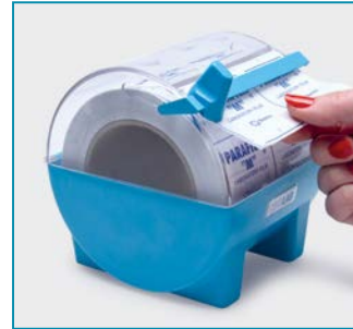
Dispenserden gerektiği kadar parafilm çekerek dışa çıkartın.
