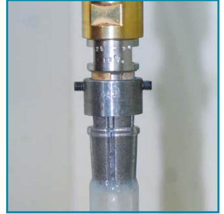
Mükemmel rodajlama kalitesi için sadece elmas uçlu rodajlama aparatları kullanılır.
