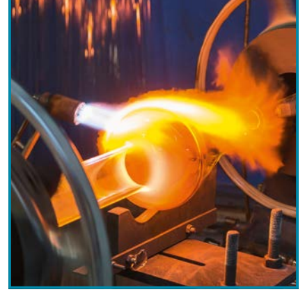
Cam borular yetenekli ve tecrübeli ustalar tarafından DIN standartlarına uygun dış boyutlar, biçim ve et kalınlığında şekillendirilirler
