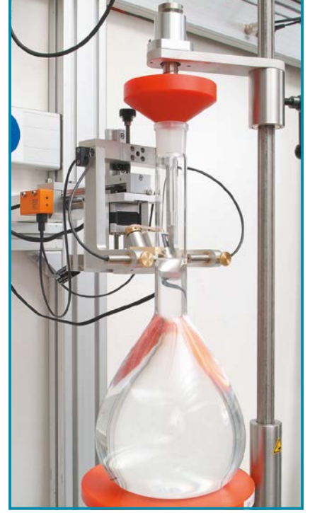
Yarı mamul ürünlere su doldurumu kalibrasyon makinası tarafından otomatik olarak yapılır.
