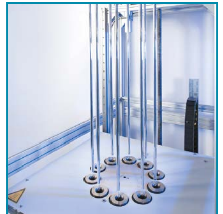
Büret boruları uzunlukları boyunca daima aynı çapa sahip olabilmeleri için vakum daraltma teknolojisi ile biçimlendirilirler.
