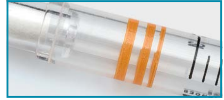
Değişik renk kodlu pipet ağzları sınıflandırmayı ve ayırt edilmeyi kolaylaştırır.
