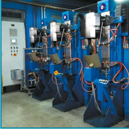
Teknoloji harikası ergitme ve kaynak makinaları cam parçaların bir diğerine eklenmelerinde kullanılır.
